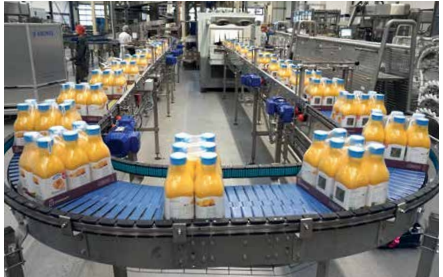
Fábrica de engarrafamento de sucos não concentrados na nova fábrica do grupo de empresas Gropper em Stockach
