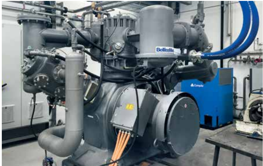
Compressor alternativo isento de óleo Tipo WH 29 3N, acionado diretamente com um motor sem eixo de 435 HP e fluxo de volume máximo de 1.024 CFM (FAD) a 580 psig
