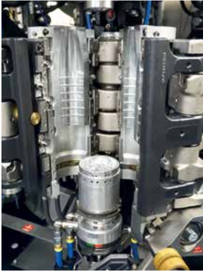
As garrafas premoldadas do tamanho de um polegar são "infladas" com ar comprimido a pressões de até 580 psig.
